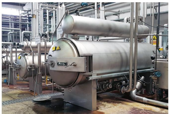
KRANTZ Levent Boya Makineleri 75'den fazla ülkede başarı ile çalışmaktadır. KRANTZ HT Levent Boya Makineleri 10 m ile 7000 m arası yükleme kapasitelerinde, 140 C° santigrat işletme sıcaklığında, ve 1:6 ile 1:8 banyo oranı aralığında çalışacak şekilde sevk edilirler.
